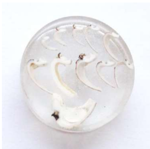
Рис. 2. Блок из эпоксидной смолы с замковыми частями раковин, подготовленный для шлифовки на станке EcoMet 250
