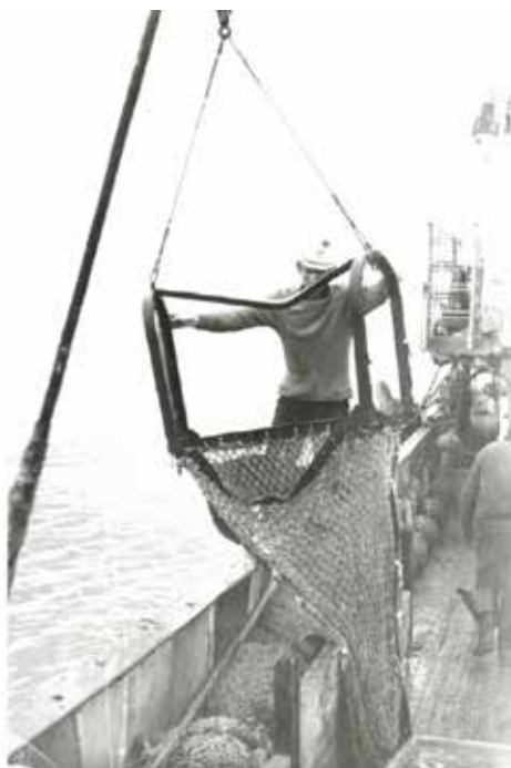
Подъем трала Сигсби на НИС «Выцегда». Работы в прибрежье Восточного Мурмана в августе 1977 г. А.М. Сенников. Фото из архива А.М. Сенникова
