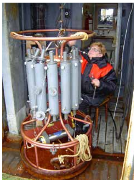
Н.Г. Пуоджюнас на борту НИС «Фритьоф Нансен» в Норвежском море при отборе проб воды на гидрохимический анализ. 2005 г.
