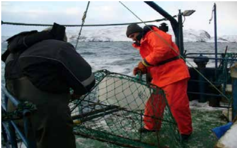
Экспериментальные работы на промысловом судне по исследованию влияния селективных окон на размерный состав камчатского краба в ловушках. 2015 г.
