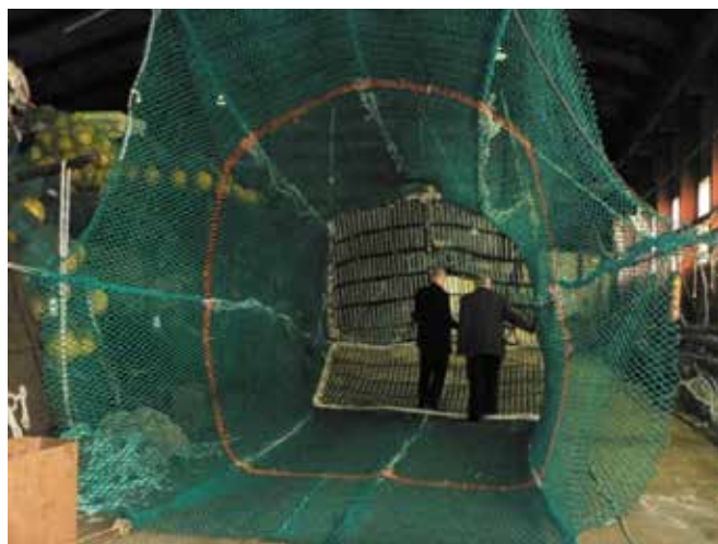
Сортирующая система пелагического трала. Фабрика по производству орудий лова. Мурманск. 2009 г. Автор фото А.А. Павленко
