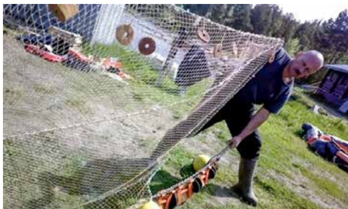
Подготовка модели нового трала к испытаниям. Научно-экспериментальная база ПИНРО на Белом море. Губа Палкина. 2019 г. Автор фото А.А. Павленко
